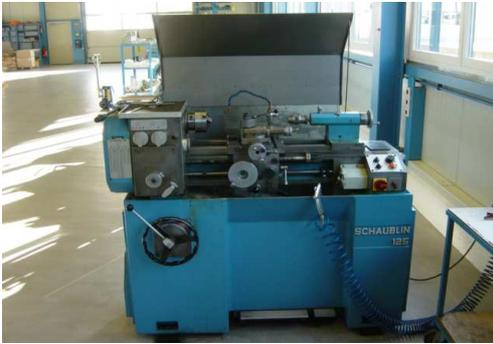
**Drehmaschine konventionell. Schaublin 125.**
