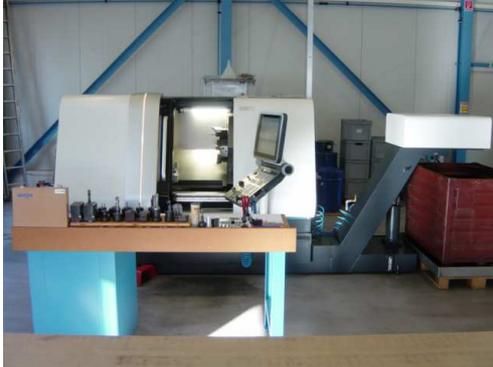
**CNC Drehmaschine DMG NEF400** mit C-Achse und 6 angetriebenen Werkzeugen, Ø350x650mm. Stangendurchlass 52mm.
